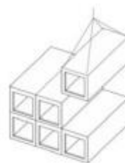
Holzmodulbau Vorgefertigte Raumzellen
