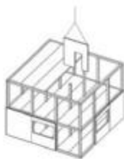
Holzskelettbau Kombination Einzelteile und Elemente
